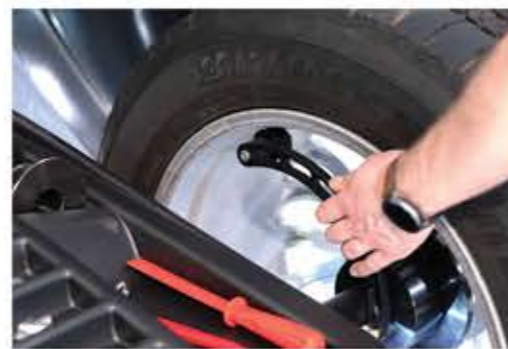
Электронная измерительная линейка (ЭИЛ) дает возможность автоматически определять координаты установки уравнивающих грузов на внутренней поверхности дисков. Рукоятка ЭИЛ позволяет точно позиционировать и устанавливать грузы на клеящейся основе.
