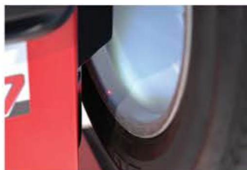
Лазерный указатель для точного обозначения места установки грузов на клеящейся основе
