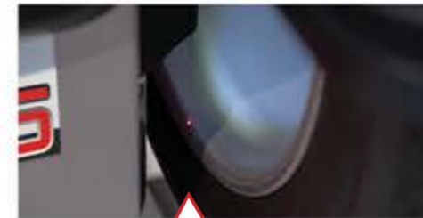
LP (laser pointer) Лазерный точечный указатель для точного обозначения места установки грузов на клеящейся основе
