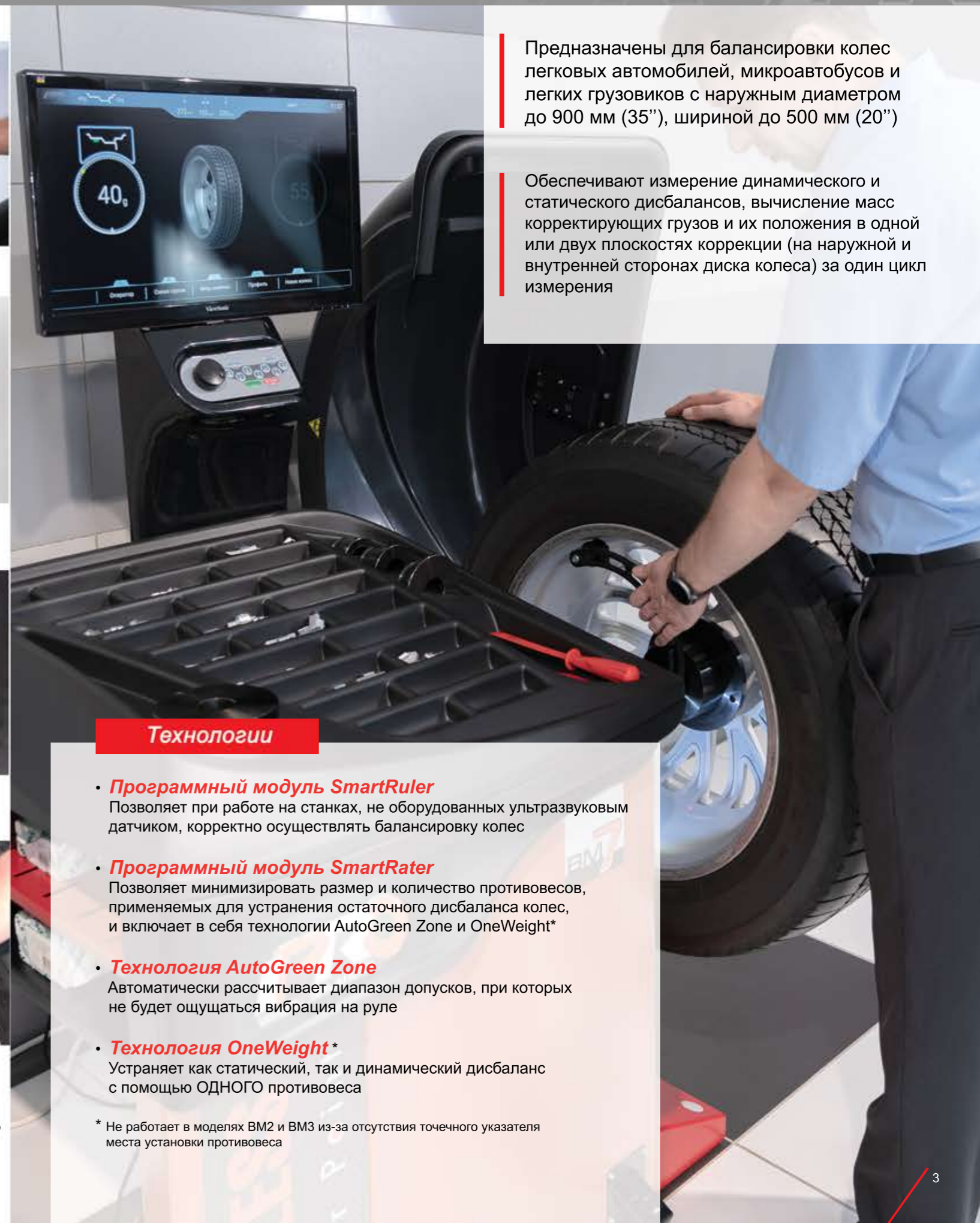
Электронная измерительная линейка (ЭИЛ) дает возможность автоматически определять координаты установки уравнивающих грузов на внутренней поверхности дисков. Рукоятка ЭИЛ позволяет точно позиционировать и устанавливать грузы на клеящейся основе.
