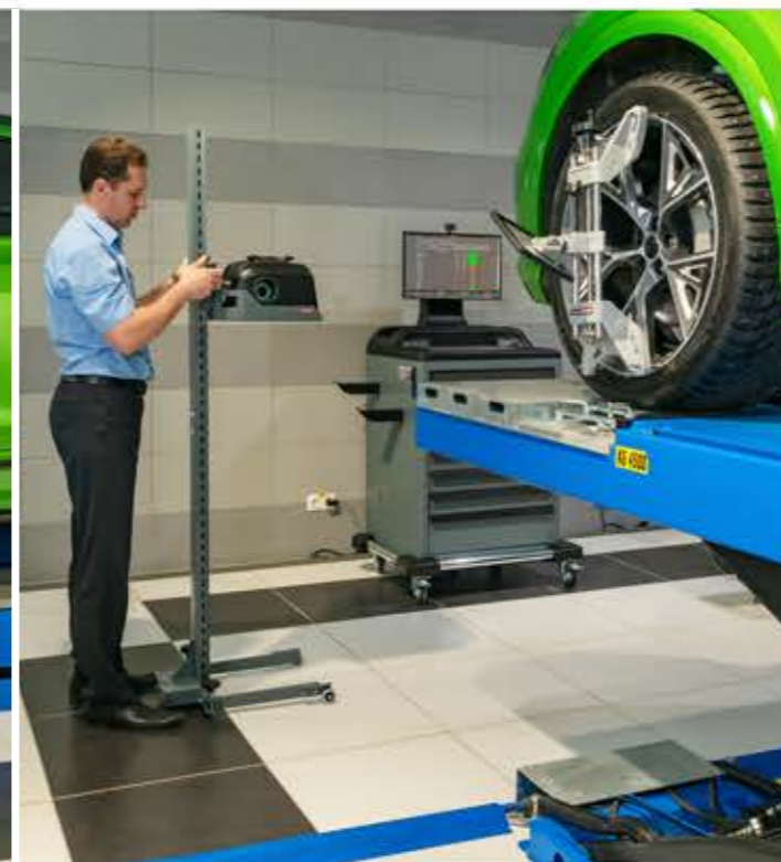
Мобильные универсальные кронштейны - стойки с возможностью регулировки высоты измерения
