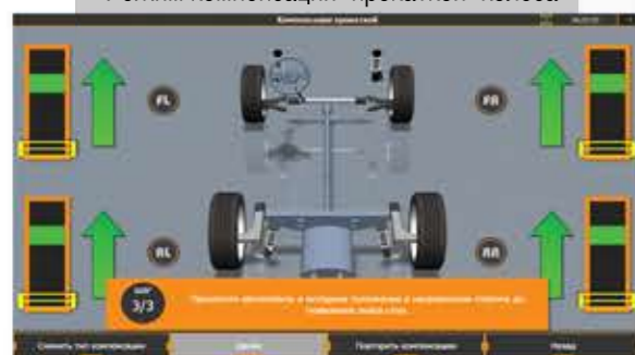
Режим компенсации "прокаткой" колеса
